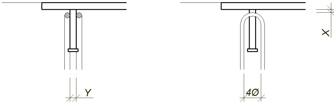
Abbildung 2.15: Anordnung der Rückhängebewehrung mit Werten X und Y so klein wie möglich
