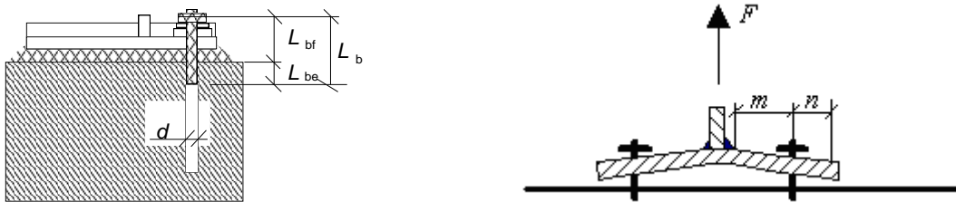
Abbildung 4.1: Länge der Ankerschraube (links) und von der Betonoberfläche losgelöster T-Stummel [53] (rechts)
