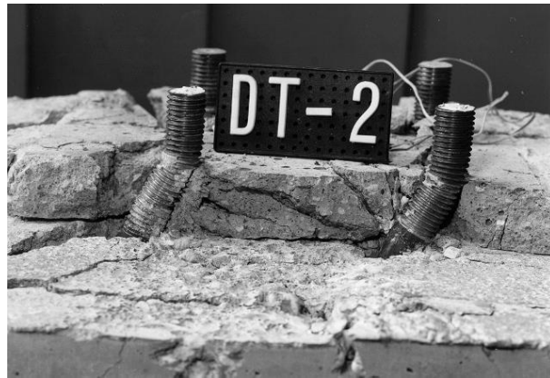
Abbildung 4.17: Ankerbolzen unter Schub- und Zugbeanspruchung
