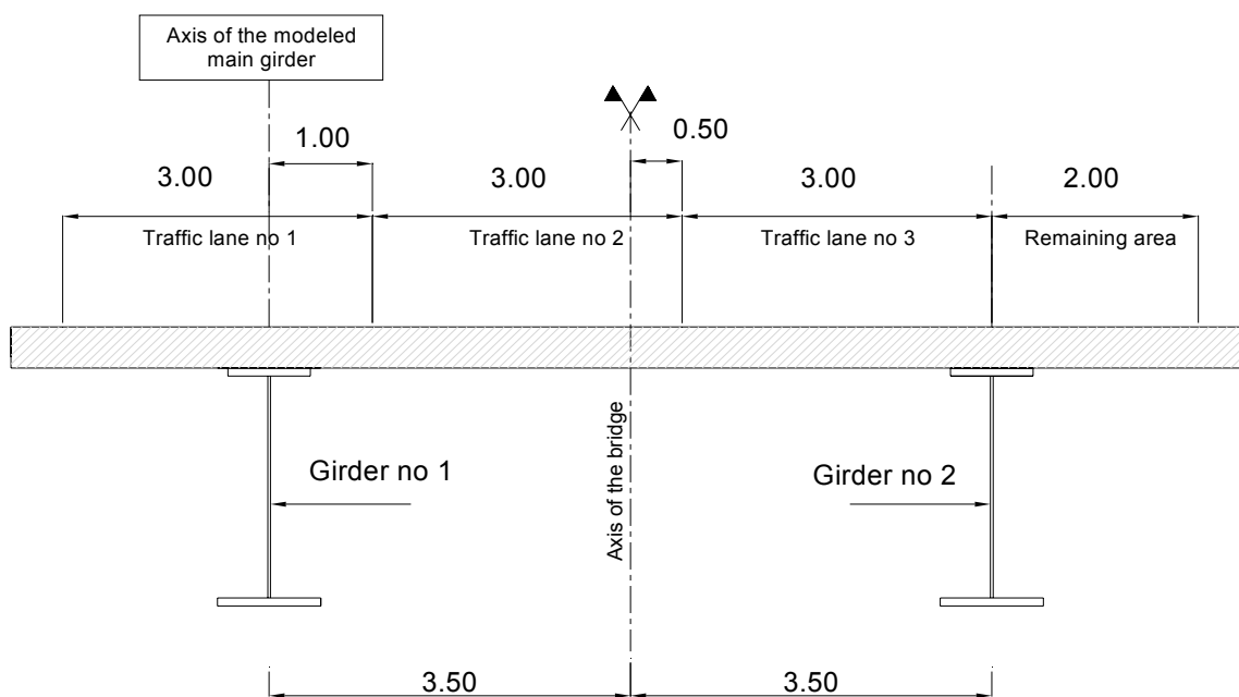
Abbildung 2-17: Anordnung der Fahrbahnen für die Berechnung des Trägers Nr. 1
