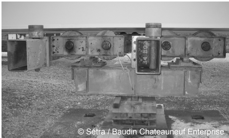
Abbildung 7-3: Verschiebelager mit vier Rollen und zwei seitlichen Führungsrollen (Gesamtlänge = 1,25 m).
